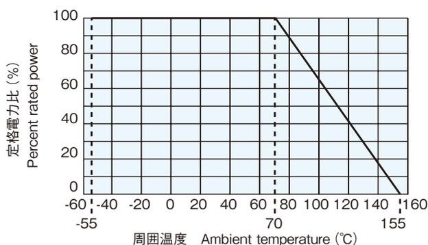
周囲温度70℃以上で使用される場合は、上図負荷軽減曲線に従って、定格電力を軽減して御使用ください。
